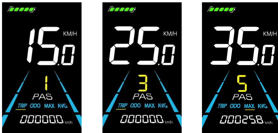
Figure 5-4 PAS level display interface
